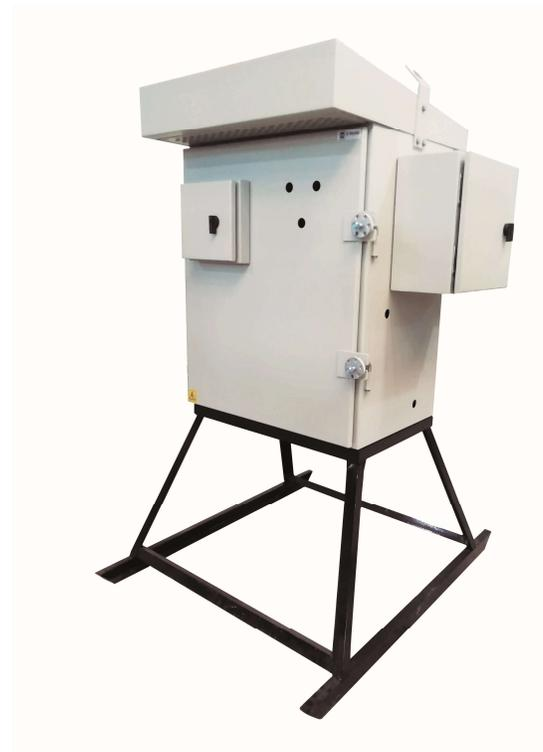
En su parte superior posee un sobre techo que supera convenientemente las dimensiones del gabinete evitando la acumulación de agua o nieve. En el interior del mismo se aplica un compuesto especial para evitar la condensación de la humedad ambiente. Para facilitar la evacuación de la temperatura generada por los componentes alojados en su interior posee en su parte inferior unas rejillas de ventilación que evacúan la temperatura mediante la convección natural del aire.
